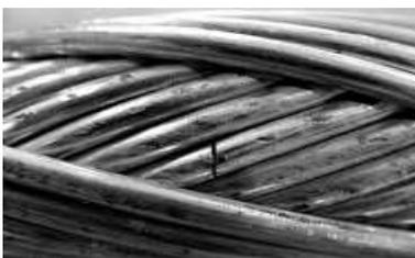
Fig 1. (d) Fatigue breaks
